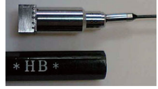
当研究室で開発された「鉛筆サイズ」分光偏光計。
